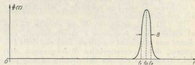
Fig. 2. - Generico andamento della densità spettrale del rumore termico filtrato da un circuito selettivo per alta frequenza.
