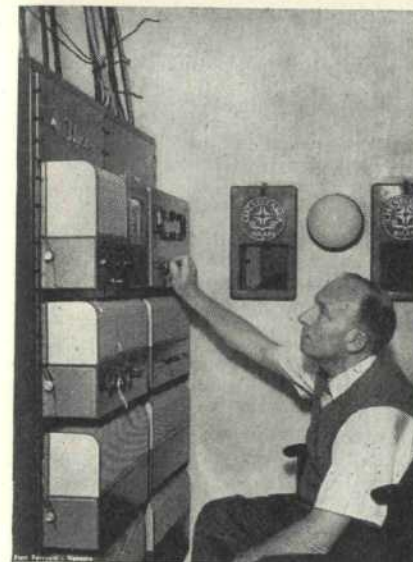
Fig. 19. - I pannelli amplificatori-ricevitori del complesso di proiezione televisiva per grande schermo cinematografico, tipo PT100-RCA.
