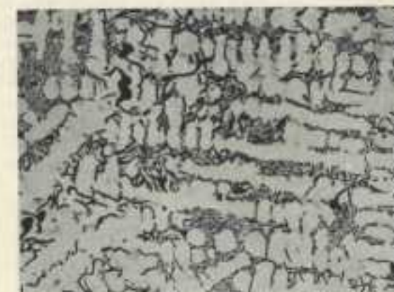
Fig. 10 - Att. Nital - FeO nelle scorie 7%.
