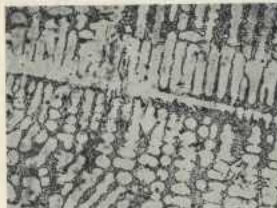
Fig. 11 - Att. Nital - FeO nelle scorie 5,98%.
