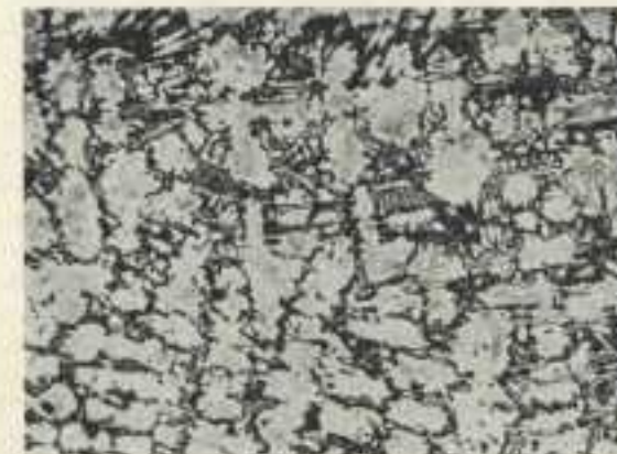
Fig. 8 - Att. Nital - FeO nelle scorie 10,93%.
