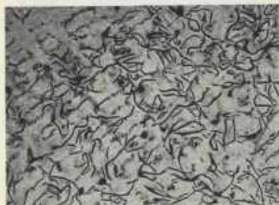
Fig. 13 - Att. Nital - FeO nelle scorie 3,51%.
