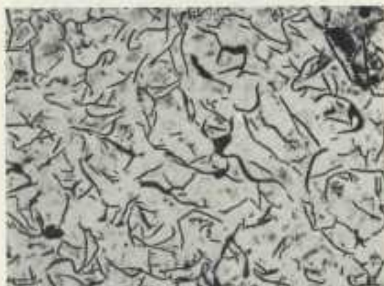
Fig. 14 - Att. Nital - FeO nelle scorie 2,97%.
