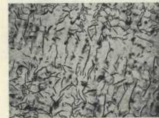
Fig. 12 - Att. Nital - FeO nelle scorie 5 %.
